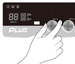
PLUS系列：初次开机，时间显示屏会随机显示，进度条指示灯常亮，向右旋转旋钮加时间，向左减时间。对应显示屏左边两位数字随之变动，时间设置成功，按压旋钮，超声波启动。
